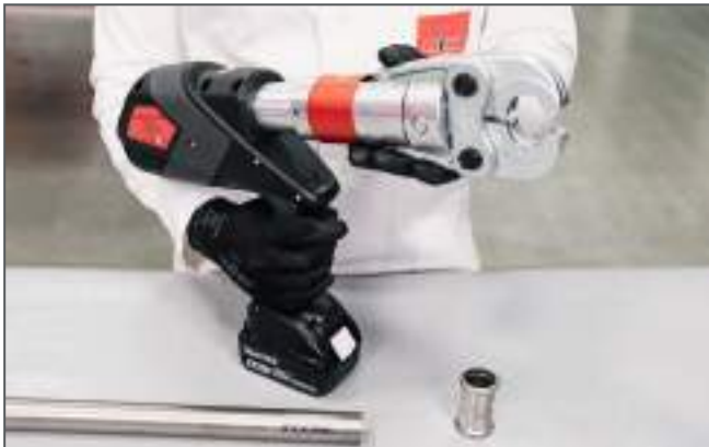
Preparazione della macchina pressatrice / Press machine preparation
